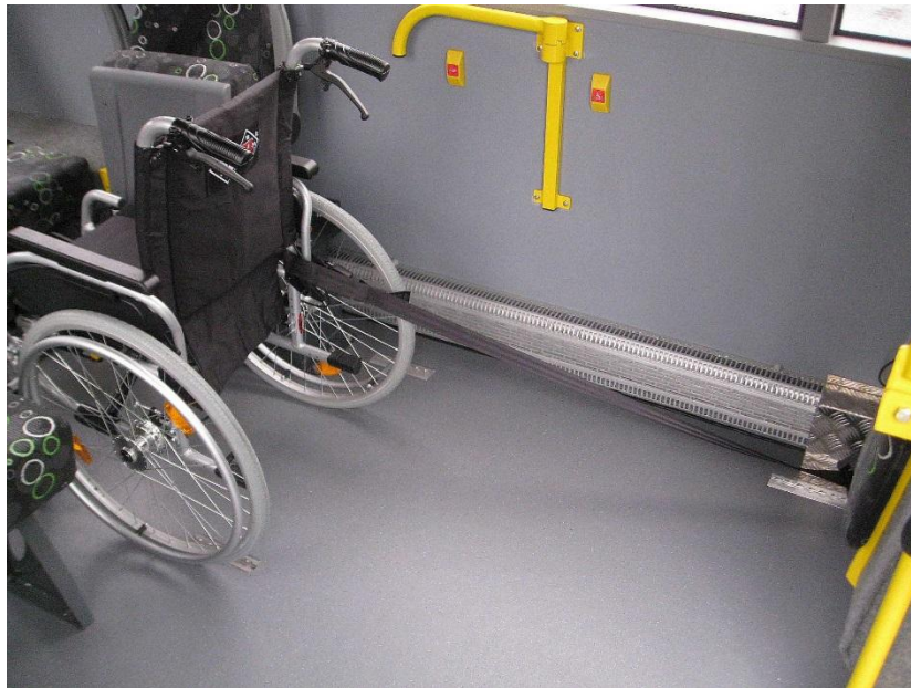
Abb. 11: Gurt herausziehen und mit Schlaufe oder Gurtschloss am Rollstuhl befestigen; an diesem Standpunkt des Rollstuhls gut zugänglich
