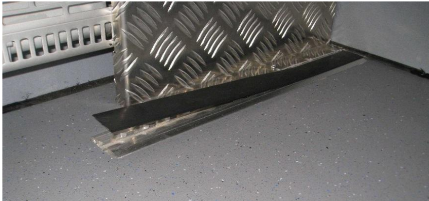
Abb. 8: Abdeckungen der Cargo-Schienen entfernen, Rollstuhl neben Drehsitz schieben – viel Platz als Rangierfläche
