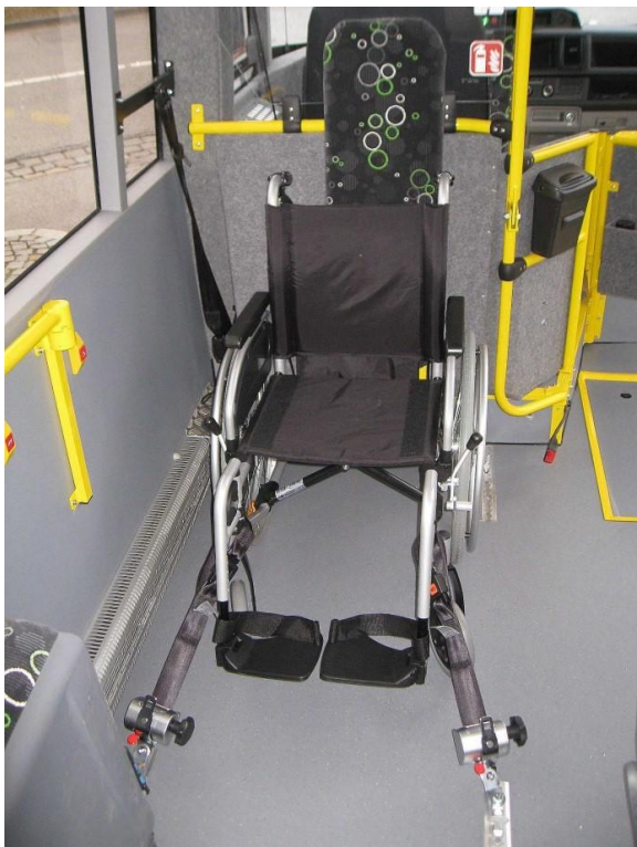
Abb. 12: Nun Befestigung an den Bodenpunkten vorne und hinten. Mit den Handrädern an den Gurten kann der Rollstuhl festgezurrert werden.
