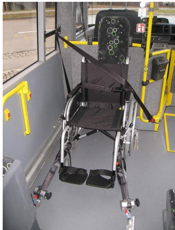
Abb. 13: Nun den Rollstuhlinsassen mit dem 3-Punkt-Gurt anschnallen.
