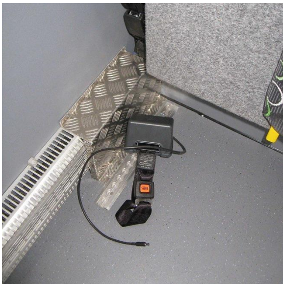
Abb. 9: Elektrischer Retraktorgurt so nah am Abschluss der Fahrerkabine wie möglich in die Cargo-Schiene einsetzen.
